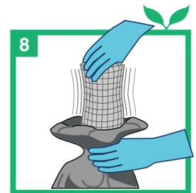
8 **Vacíe o cambie la bolsa de la aspiradora en una bolsa de plástico y verifique los filtros cada dos horas o cuando estime necesario.**
