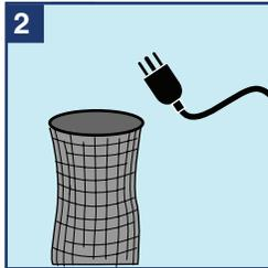
2 Asegúrese que la bolsa del filtro y el cable estén en condiciones apropiadas. Enchufe la maquina.
